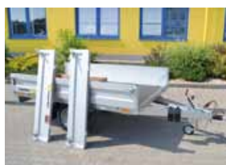
Odnímatelná čela a bočnice přívěsu
