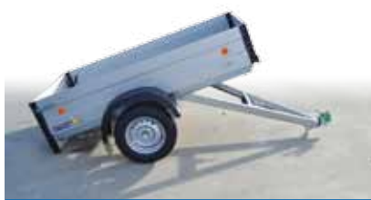
ALUX-3 N1 750 kg ve sklápěném provedení a s odnímatelným zadním čelem
