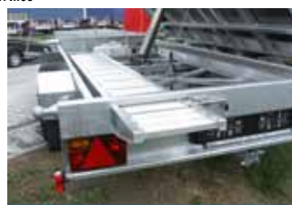
Uschovatelné hliníkové nájezdy ve spodním rámu
