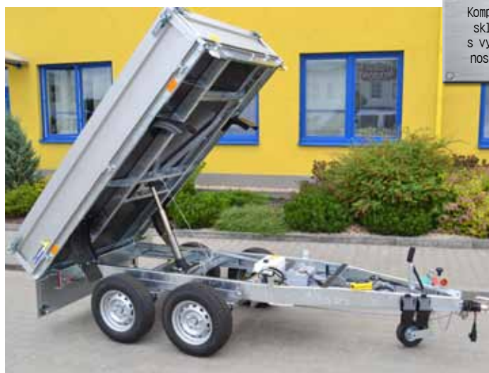
Přívěs Delta B2 s elektrickým ovládáním hydrauliky
