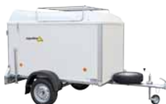
Přívěs VZ-21 O s rezervním kolem, opěrnými nohama a laminátovým víkem
