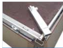
Kotvici třmeny v boční liště přívěsu
