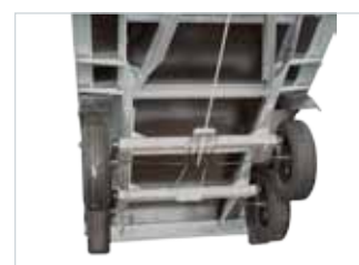
Masivní celosvařená konstrukce přívěsu
