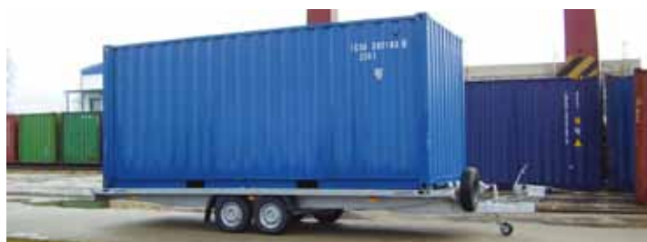
Přívěs DONA v úpravě pro převoz prázdných ISO kontejnerů a buněk
