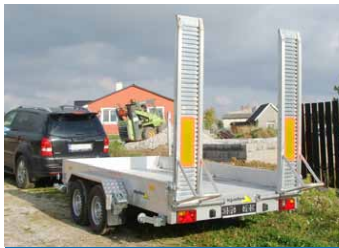
Zadní integrované hliníkové nájezdy
