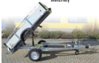
Přívěs VZ-26 B1 s hydraulicky sklopnou korbou
