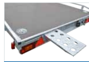
Odnímatelné nájezdy a kotvící misky v podlaze
