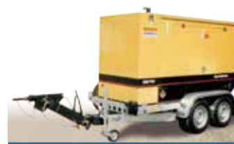
Podvozek pod EC s výškově stavitelnou ojí
