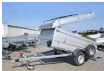
Sklopný brzděný přívěs VZ-26 s hliníkovými bočnicemi, s rezervou, nástavbou bočnic a laminátovým víkem
