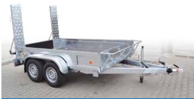
Zadní integrované železné nájezdy s vysokou nosností
