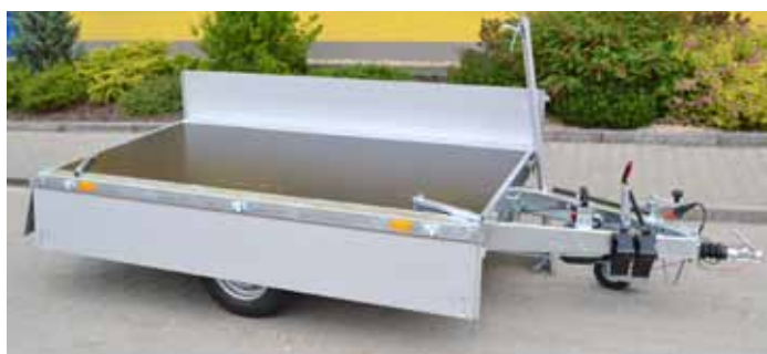
Snadné sklopení a odejmutí bočnic a sloupky
