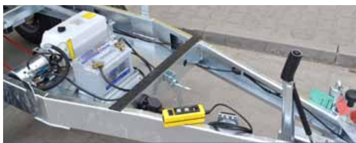
Elektrické ovládání hydrauliky s odnímatelným ovladačem
