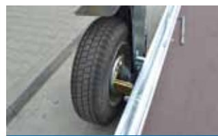
Hydraulicky sklopná náprava
