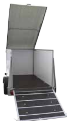
Zadní rampa s možností protiskluzové úpravy
