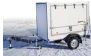
Přívěs VZ-21 s boční klapkou a výškově stavitelnou ojí
