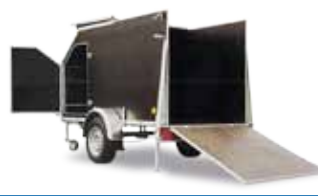
Brzděný přepravník balónů se zadní rampou a odnímatelnou střechou
