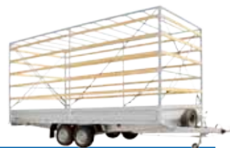
Masivní plachtová konstrukce s odnímatelnými horními příčkami
