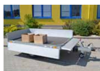
Snadné sklápění hliníkových bočnic
