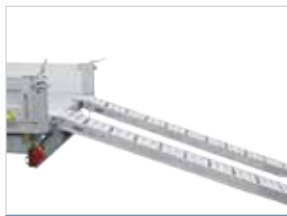
Odnímatelné hliníkové nájezdy
